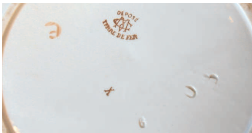
Fig. 49 - Outre les repères de l'ouvrier mouleur, à droite, on observe un 6 en creux qui donne la taille de ce plat rond ; le X imprimé est le repère de l'imprimeur et le E peint est celui du peintre ; la marque C&M imprimée date d'après 1884.
