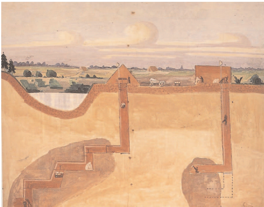
Fig. 4 - Vue en coupe d'une mine de terre plastique. © Musée communal de la Céramique d'Andenne.
